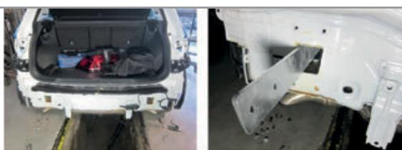
**ШАГ 2.** Закрепите каждую закладную пластину с помощью болта M10x1,25x40 и шайб 10 в дальнем отверстии закладной пластины. Установите балку ТСУ, совместив его отверстия с отверстиями в закладных пластинах и соедините их с помощью болтов M10x1,25x40, через шайбы 10 гроверные и шайбы 10, гайками M10x1,25.
