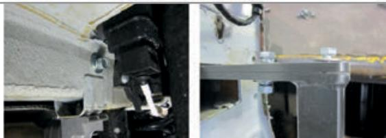
**ШАГ 3.** Закрепите каждую закладную пластину в ближнем отверстии с помощью болта M10x1,25x40 через шайбу 10 гроверную и шайбу 10. Затяните все резьбовые соединения. Перед установкой бампера наклейте на нижнюю юбку бампера шаблон по центру бампера и аккуратно вырежьте по контуру шаблона отверстие в бампере.
