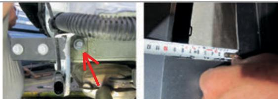
**ШАГ 4.** Установите бампер и фонари на место. Установите кронштейн нижний, совместив отверстия в нём с отверстиями в балке ТСУ. Закрепите нижний кронштейн с помощью болтов M12x1,25x120 и гаек M12x1,25 с нейлоном. Установите кронштейн розетки, закрепив его на шпильке гайкой M10 через шайбу 10 увеличенную и шайбу 10 гроверную.
