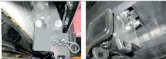
**ШАГ 5.** Установите съёмный шар в сборе и закрепите его пальцем гнутым гальванизированным со шплитом пружинным игольчатым. Затяните шар ключом на 38 мм. Установите фиксирующий болт M10x20 снизу, он используется для исключения технологических люфтов съемного шара и только в ненагруженном состоянии! Перед сцепкой болт демонтировать!
